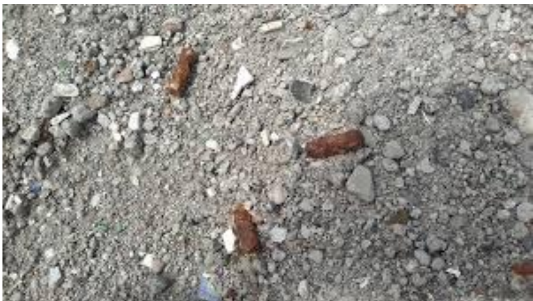
Beaumix: opgewerkte bodemas met batterijen zichtbaar
