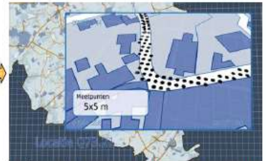
afb. 2. Meetpunten omzetten in grid van 5 x 5 meter
